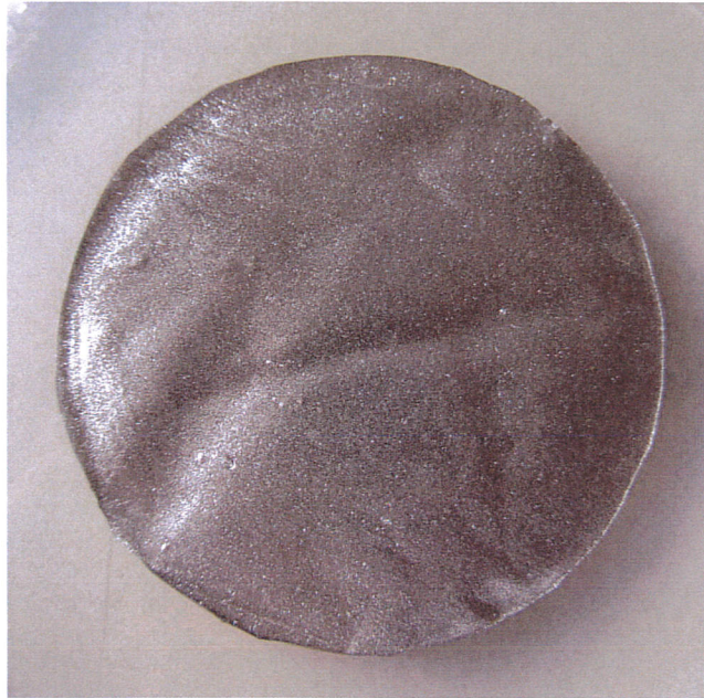
Foto 1: Untersuchungsmaterial technicoll 9707, Farbe silber nach einer Inkubationszeit von 28 Tagen ohne sichtbaren Pilzbewuchs
